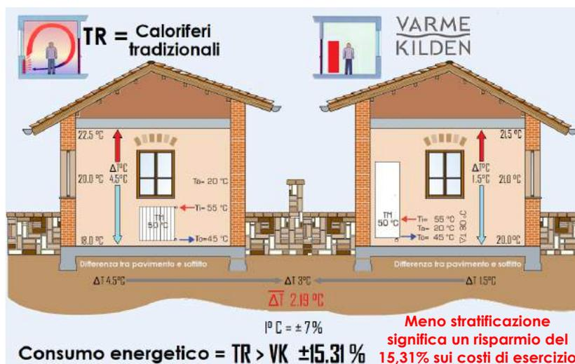
Limitare la stratificazione termica a 0,5°C per ogni metro d'altezza del locale; significa che su locali alti 3 mt si avrà una differenza massima tra pavimento e soffitto di 1,5°C contro i circa 4,5°C dei normali caloriferi convettivi. Quindi se siamo noi ad avere freddo perché scaldare il soffitto? E perché riscaldare l'aria quando siamo noi ad aver necessità di comfort?
