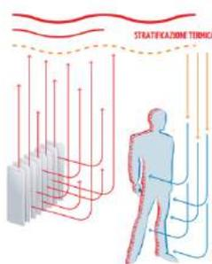
**Cos'è la convezione:** Il riscaldamento di tipo convettivo scalda prevalentemente l'aria ambiente che stratifica sul soffitto e comunque poi deve essere ovviamente cambiata con l'esterno causando una perdita di energia
